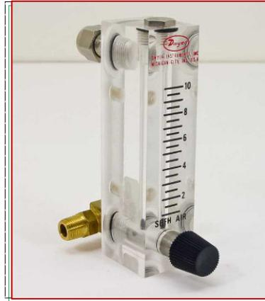
الشكل (3-3): صورة لمقياس تدفق الهواء
